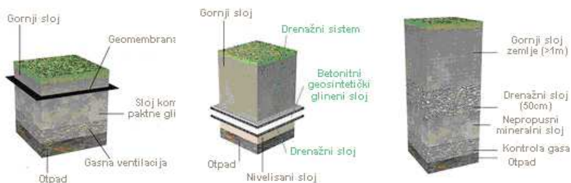
Слика 5.19. Приказ горњих покривних слојева депоније
